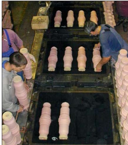
**Bild 3.15:** Formstückherstellung mit verlorenen Kernen
