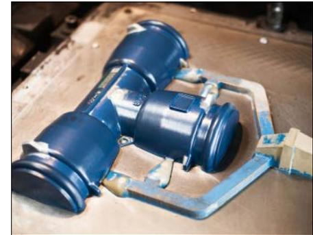
**Bild 3.16:** Modell zur Herstellung des Sandabdruckes
