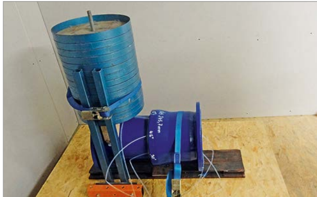
Prüfaufbau für TYTON® - Steckmuffen-Verbindung
