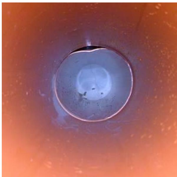
**Abb.64:** Rohrverbindung Wavin KG PVC nach einem Außenüberdruck von 3,89 bar. Wassereintritt durch Verformung des Spitzendes.
