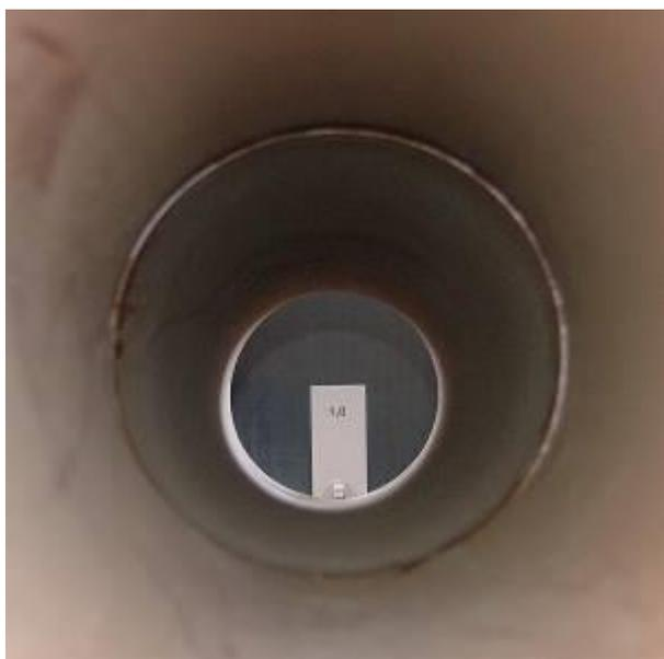
**Abb.48:**Rohrverbindung Euroceramic Eurotop DN 150, bei einem Außenüberdruck von 1,0 bar. Kein Wassereintritt.
