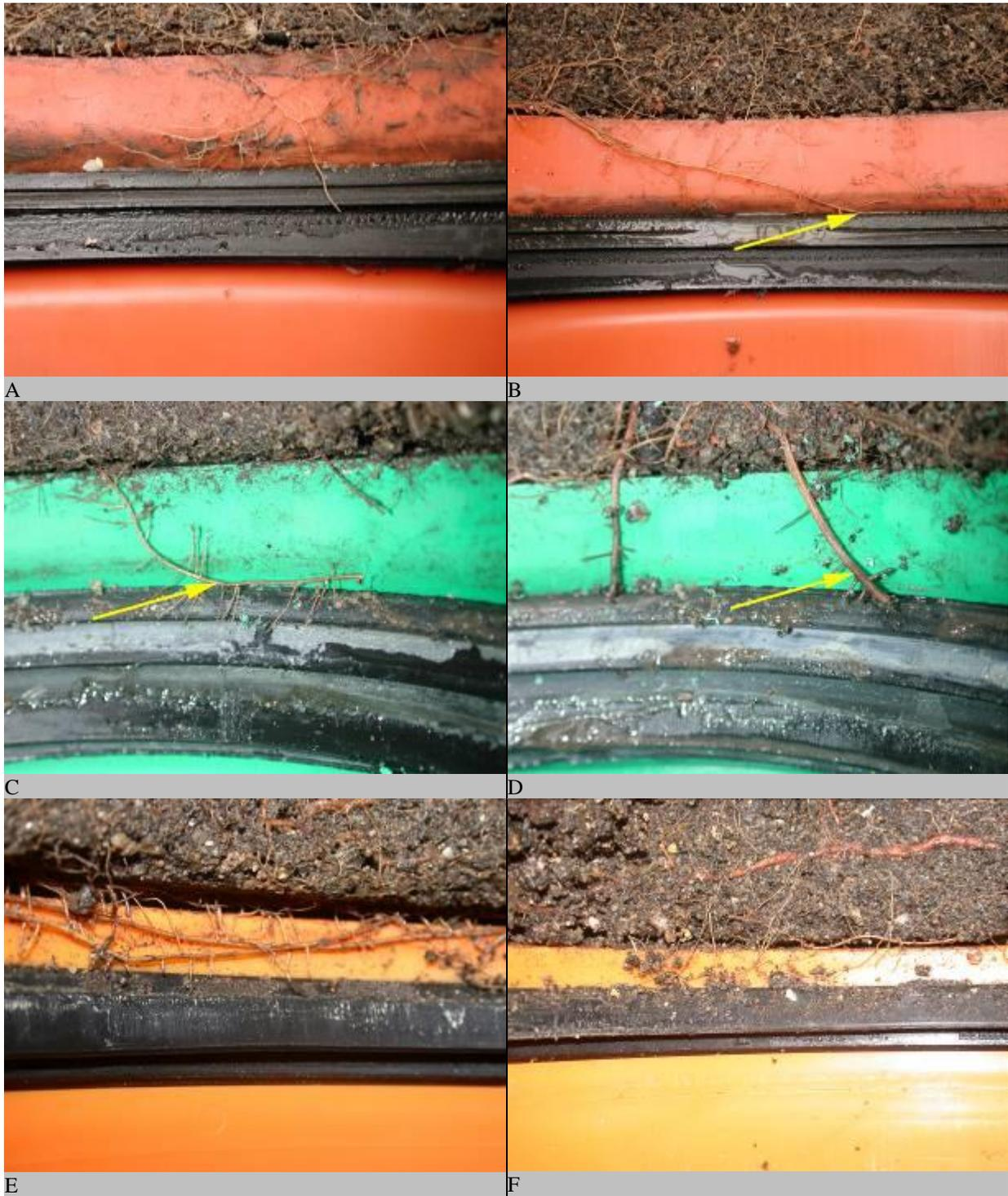
**Abb. 96:** Auswertung der Outside-In-Versuche **A** Rehau PVC SN 8 - Variation 1. **B** Rehau PVC SN 8 - Variation 2. Die Wurzeln befinden sich in direkter Nähe zum Dichtelement (Pfeil). **C** Ostendorf KG 2000 PP - Variation 1. Wurzeln befinden sich unterhalb des Dichtelementes (Pfeil). **D** Ostendorf KG 2000 PP. Die Wurzeln befinden sich in direkter Nähe zum Dichtelement (Pfeil). **E** Rausisto SN 10 PP - Variation 1. **F** Rausisto SN 10 PP - Variation 2.
