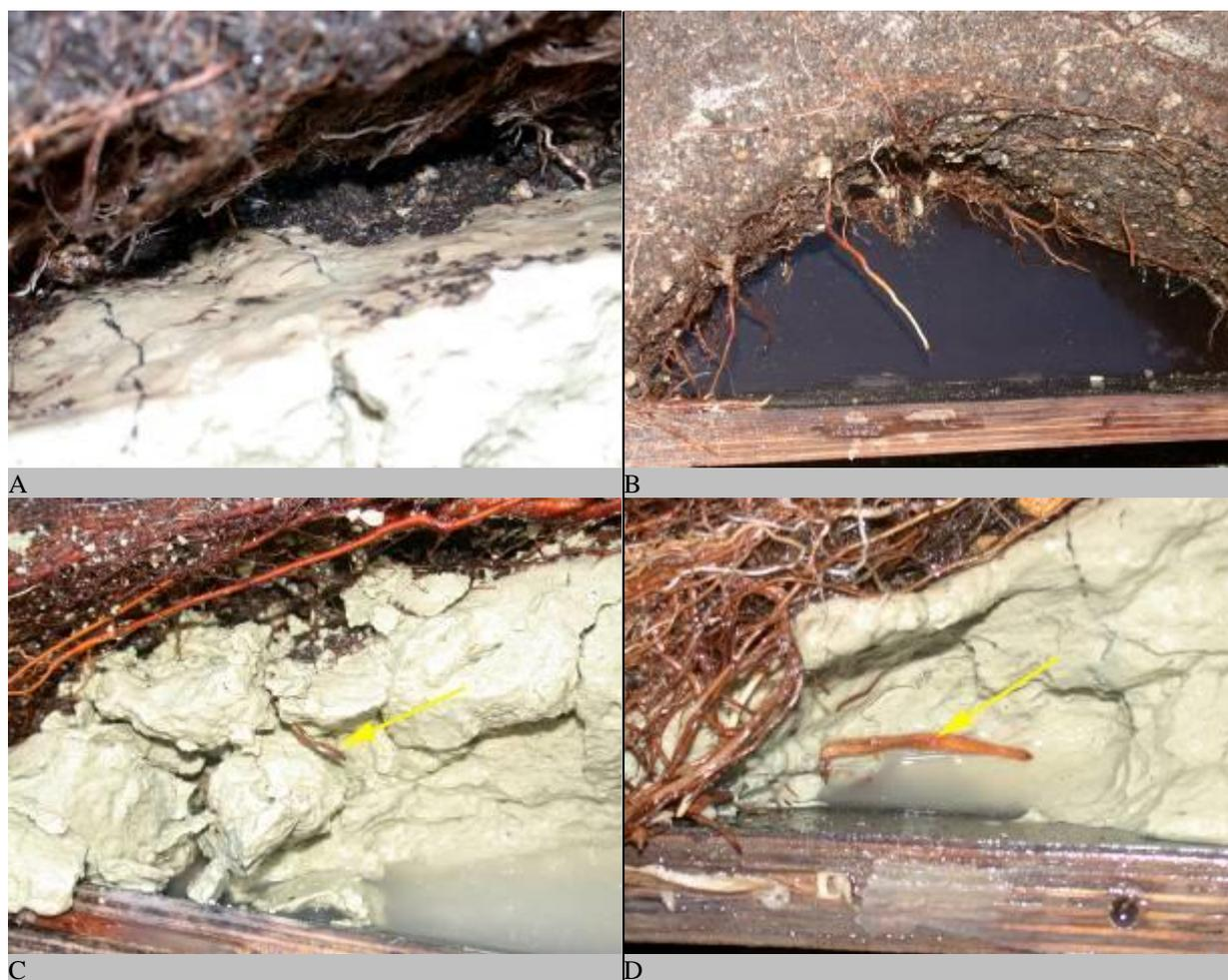
**Abb. 116:** Untersuchung des Einflusses des Porenraumes auf das Wachstum von Wurzeln. **A** Im Bodenkörper aus Bentonit traten Fissuren auf, die zum Teil mit Komposterde gefüllt waren. **B** Aus der Komposterde (Füllung des Kulturgefäßes) waren Wurzeln in das Bentonit gewachsen. **C** und **D** Innerhalb des Bentonits haben sich Wurzeln ausgebreitet (Pfeile).
