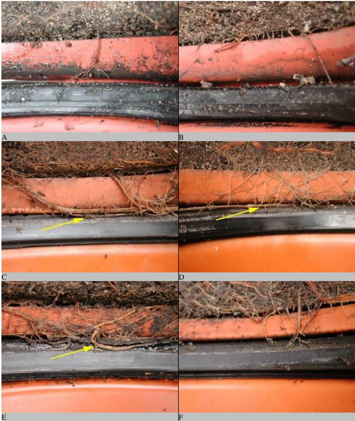
**Abb. 95:** Auswertung der Outside-In-Versuche **A** Rehau PVC KG SN 4, Variation 1. **B** Rehau PVC KG SN 4, plan - Variation 2. **C** Ostendorf PVC KG - Variation 1. Seitenwurzeln sind in Richtung des Dichtelementes gewachsen (Pfeil). **D** Ostendorf PVC KG - Variation 2. Seitenwurzeln sind in Richtung des Dichtelementes gewachsen (Pfeil). **E** Wavin PVC KG - Variation 1. Seitenwurzeln sind in Richtung des Dichtelementes gewachsen (Pfeil). **F** Wavin PVC KG - Variation 2.
