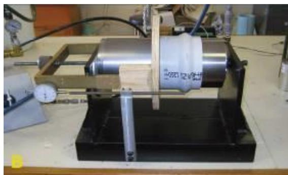
**Abb. 15:** Bestimmung des Anpressdrucks in der Rohrverbindung nach AS 1462 Part 13: **A** Schematische Darstellung des Versuchsaufbaus (vgl. [54]). **B** Versuchsstand mit Weg- und Druckmesseinrichtung (vgl. [54]).
