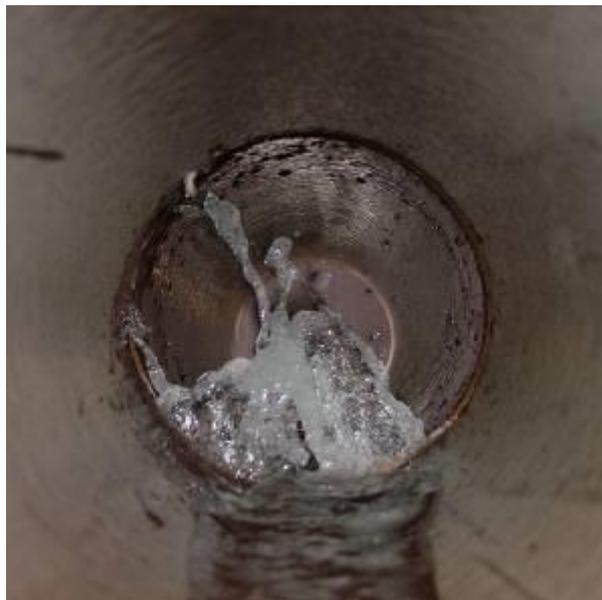
**Abb.42:** Rohrverbindung Steinzeug Cerafix DN 150. Angestrebte Druckstufe 1,5 bar. Hier Wassereintritt bei einem Außenüberdruck von ca. 1,4 bar. (vgl. **Tabelle 6**).
