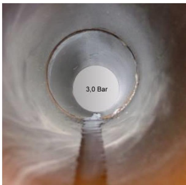
**Abb.46:** Rohrverbindung Euroceramic Eurotrade DN 150. Angestrebte Druckstufe 3 bar. Hier Wassereintritt bei einem Außenüberdruck von ca. 2,2 bar.
