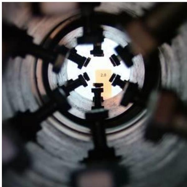
**Abb.82:** Rohrverbindung Rehau Awadukt SN 10 Rausisto, bei einem Außenüberdruck von 2,0 bar. Kein Wassereintritt.
