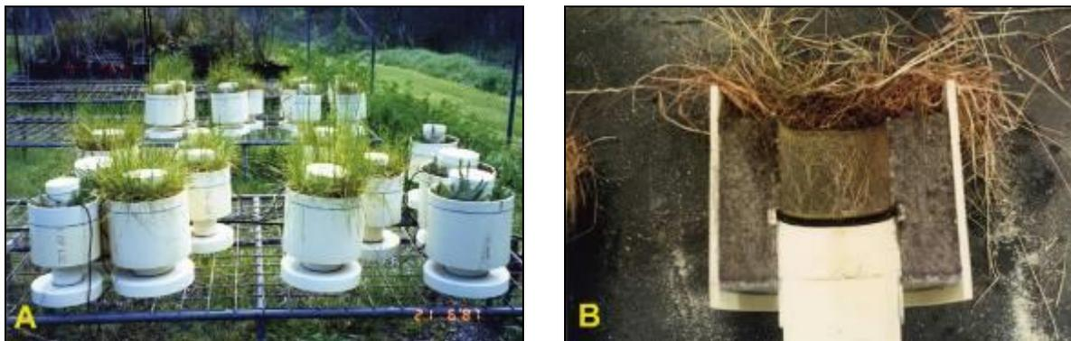
**Abb. 16:** Vertikale Versuche des CSIRO, Australien: **A** Rohrverbindungen im bepflanzt Zustand. **B** Rohrverbindung nach dem Ausbau, längs aufgeschnitten [54].
