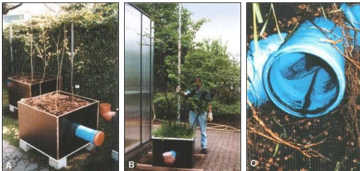
**Abb. 14:** Versuchsaufbau zur Prüfung der Wurzelfestigkeit von PVC-Rohren der Funke Kunststoffe GmbH: **A** Versuchsaufbau nach der Pflanzung in einem mittelformatigen Versuchszustand im Jahr 1996; **B** Versuchspflanzung im Jahr 2000; **C** Intensive Durchwurzelung im Substrat, keine Wurzeln in den Rohrverbindungen im Jahr 2000. (aus [50])
