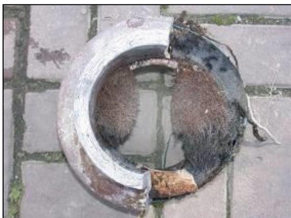
**Abb. 9:** Blickrichtung gegen Fließrichtung. Die Rohrverbindung wurde geöffnet und eine Hälfte entfernt. Der mittlere Wasserstand bei Betrieb der Rohrleitung wird durch den Belag in der Sohle deutlich.
