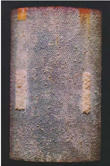
Bild 14.1: Selbstheilung von künstlichen Verletzungen durch Zink-Reaktionsprodukte
