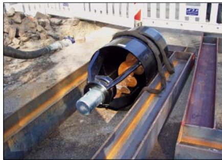
Bild 22.19: Zugkopf mit innenliegender Förderschnecke
