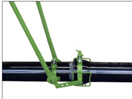
Bild 19.21: Beispiel eines Montagegerätes für das Zusammenziehen von duktilen Gussrohren ≤ DN 300
