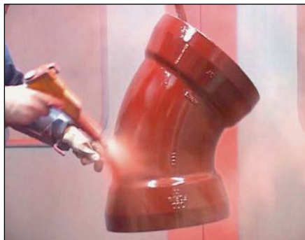
Bild 15.4: Elektrostatischer Epoxidharzpulver-Auftrag mit Sprühpistole
