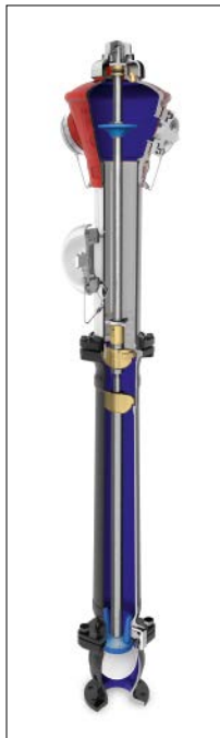
Bild 7.8.3-06: Schnittbild eines Überflurhydranten DN 100 mit 2 Abgängen B und 1 Abgang A mit Edelstahlsäule
