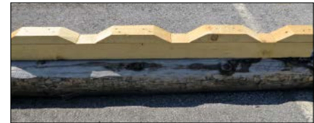
Bild 19.3: Lagerholz für das Stapeln von duktilen Gussrohren
