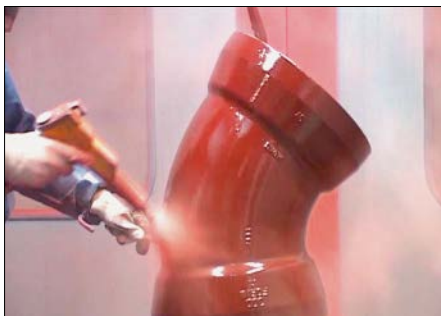
Bild 3.30: Elektrostatischer Epoxidharz-Pulver-Auftrag mit einer Sprühpistole
