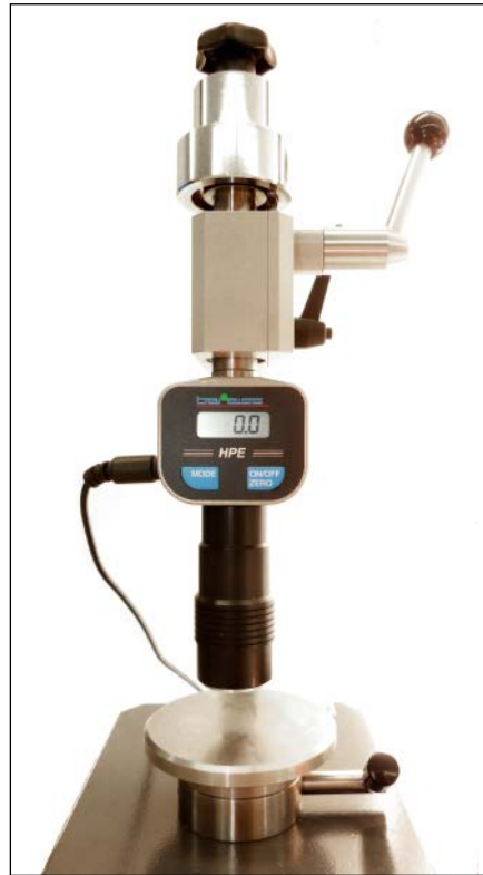
Bild 13.6: Durometer zur Messung der Gummihärte nach Shore-A
