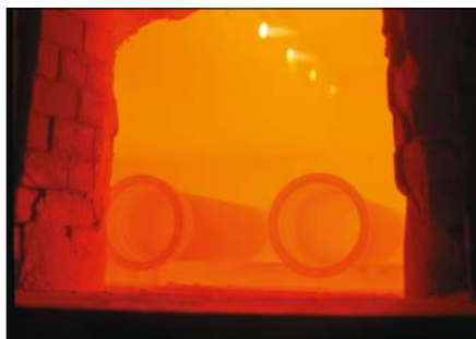
Bild 19: Rohre im Durchlaufglühofen
