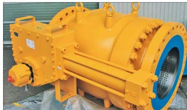
Bild 7.6.18: Pilotgesteuertes Ringkolbenventil mit Eigenmediumantrieb
