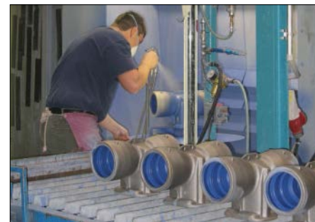
Bild 7.2.2-04: Schlickerauftrag auf der Außenseite von Schiebergehäusen durch Aufsprühen
