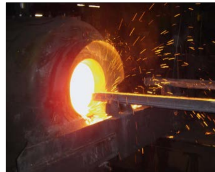
Bild 3.8: Zurückgezogene Gießrinne aus der Kokille
