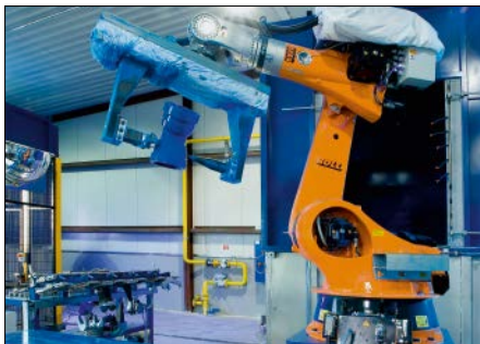
Bild 3.29: Epoxidharz-Pulver-Auftrag mit Roboter im Wirbelsinterverfahren
