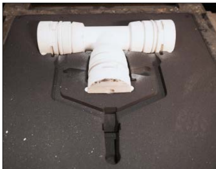
Bild 3.18: In die Sandform einlegter verlorener Kern
