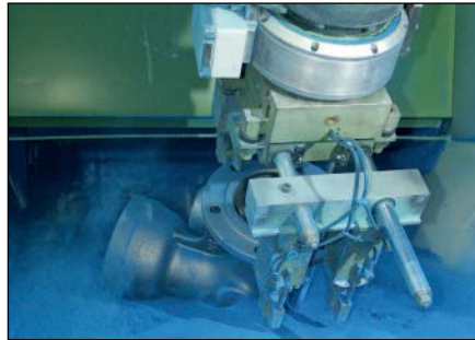
Bild 7.2.1-06: Eintauchen eines Armaturenteils in das Wirbelsinterbad
