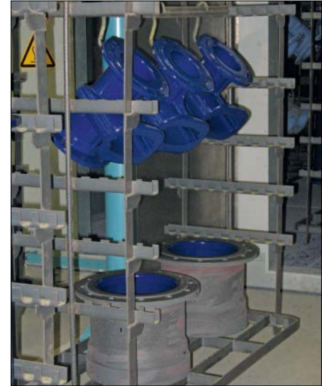
Bild 7.2.2-07: Emaillierte Schiebergehäuse und Formstücke nach dem Einbrand
