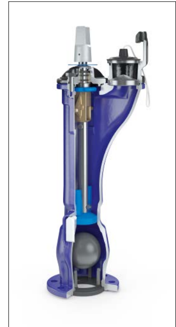
Bild 7.8.4-02: Unterflurhydrant DN 80 – doppelte Absperrung, Öffnungsrichtung entgegen der Strömungsrichtung – Vollemaillierung
