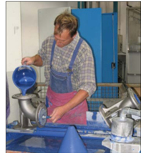
Bild 3.32: Email-Auftrag durch Fluten
