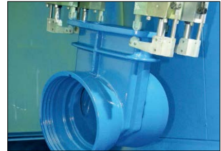
Bild 7.2.1-07: Im Wirbelsinterbad beschichtetes Schiebergehäuse
