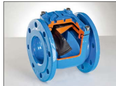
Bild 7.2.1-03: Rückschlagklappe – Außen- und Innenbeschichtungen mit Epoxidharz-Pulver nach RAL - GZ 662 [7.2-05]
