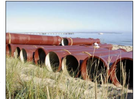
Bild 14.3: Duktile Kanalrohre nach EN 598 [14.2] mit Zink-Überzug und rotbraun eingefärbter Bitumen-Deckschicht
