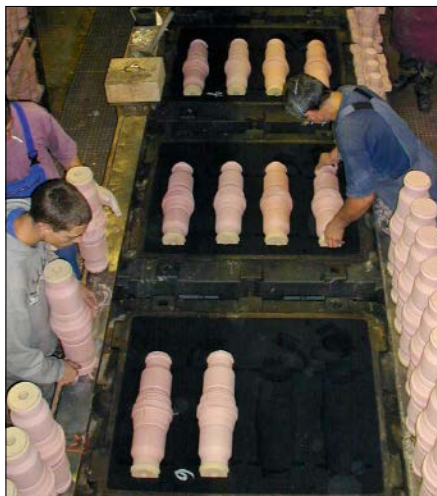
Bild 3.15: Formstückherstellung mit verlorenen Kernen
