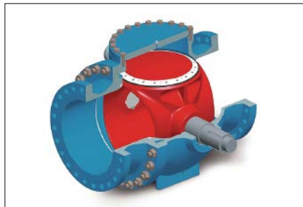
Bild 7.4.3-07: Schnittbild eines Kugelhahns – Stellung voll geöffnet
