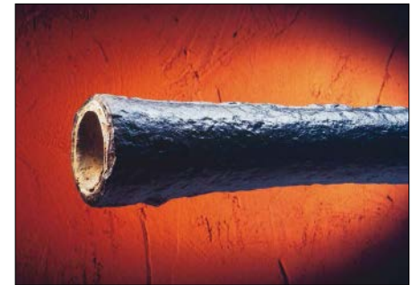
Bild 1.1 : Gussrohr der Wasserleitung aus dem Schloss Dillenburg (1455)
