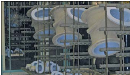
Bild 7.2.2-05: Innen beschichtete Schiebergehäuse in der Trocknungsstrecke
