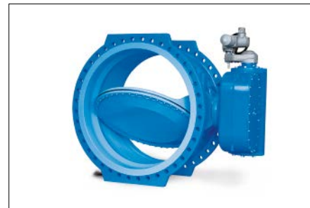
Bild 7.4.2-06: Doppelzentrische Absperrklappe mit Spindelgetriebe und Elektroantrieb für große Nennweiten, z. B. DN 1800
