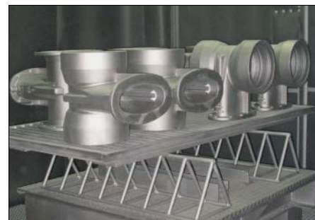
Bild 7.2.2-03: Schiebergehäuse nach Strahlbehandlung
