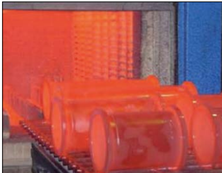
Bild 15.6: Formstücke beim Einbrand des Emails
