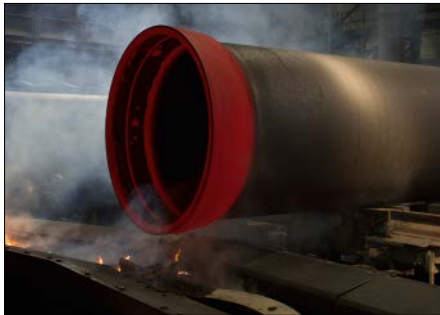
Bild 3.9: Gussrohr wird mit der Muffe voran aus der Gießmaschine gezogen
