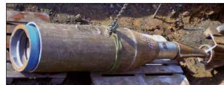
Bild 22.7: Berstkopf mit Rippen, Aufweitstufe und Zugkopf
