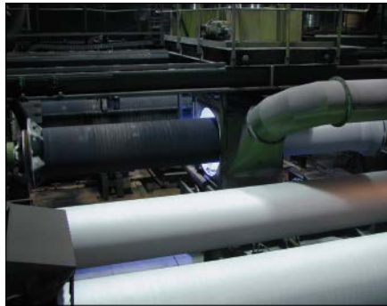
Bild 3.21: Aufbringen des Zink-Aluminium-Überzuges
