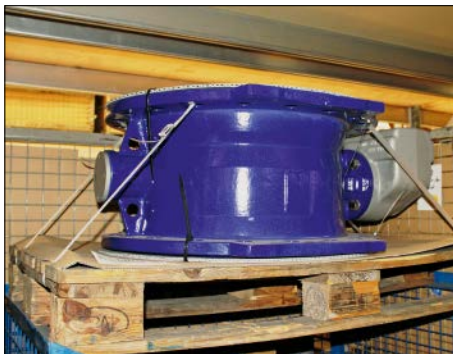
Bild 19.13: Versandfertige Kommissionierung von Armaturen auf Einwegpaletten
