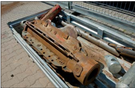
Bild 22.13: Rollenschneider für Altröhre aus Stahl
