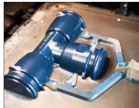
Bild 3.16: Modell zur Herstellung des Sandabdruckes
