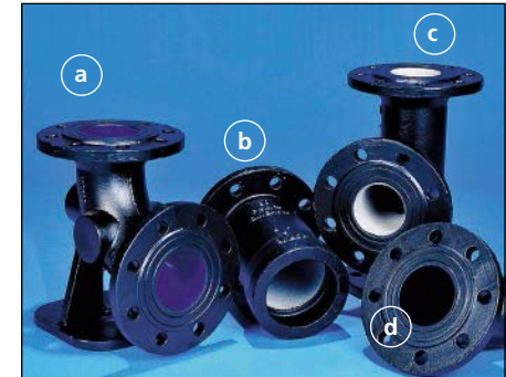
Bild 14.10: Formstücke mit einer äußeren Beschichtung aus Bitumenlack und verschiedenen Auskleidungen a) Email b) + c) Zementmörtel d) Bitumenlack
