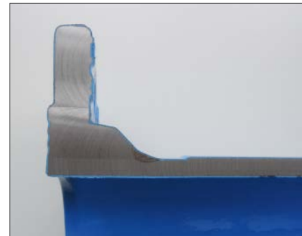
Bild 3.14: Detailaufnahme des aufgeschnittenen Schrumpfsitzes
